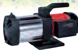
Ref. 95.815 ELECTROBOMBA SUPERFICIE EN ACERO INOXIDABLE LEADER PUMPS 1.250 W. Altura máxima: 60 m. Caudal máx.: 6.000 l/h. Bomba autoaspirante. Óptima resistencia al hielo. Para el aprovisionamiento de casa y jardín. Extremadamente silenciosa. 213,95€
