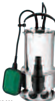
Ref. 95.822 ELECTROBOMBA SUMERGIBLE DRENAJE AGUAS SUCIAS XKS-750 SW HIDROBEX Con sólidos en suspensión Inox Hidrobex. Ø máx. de paso de sólidos 35 mm., profundidad máx. de inmersión 7 m. 750 W. Caudal máx. 13.200 l/h. Altura máx. de impulsión 8 m. Flotador incorporado y 10 m. de cable. Peso: 6,5 Kg. 79,95€
