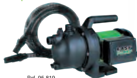
Ref. 95.819 ELECTROBOMBA SUPERFICIE EASY 600 W. Altura máx. 38 m. Aspiración máx. 7 m. Caudal máx. 2.400 l/h. Bomba auto-aspirante. Incluye kit de aspiración 7 m. 114,95€
