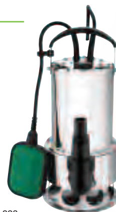
Ref. 95.823 ELECTROBOMBA SUMERGIBLE DRENAJE AGUAS SUCIAS XKS-1100 SW HIDROBEX Con sólidos en suspensión Inox Hidrobex. Ø máx. de paso de sólidos 35 mm., profundidad máx. de inmersión 7 m. 1.100 W. Caudal máx. 15.600 l/h. Altura máx. de impulsión 11 m. Flotador incorporado y 10 m. de cable. Peso: 7,2 Kg. 89,95€
