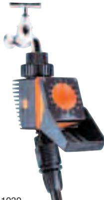
Ref. 95.1030 PROGRAMADOR DE GRIFO LÓGICA CLASSIC CLABER 15 programas prefijados que se seleccionan girando el monomando. La unidad incorpora un filtro de esponja sintética lavable. Presión de trabajo de 0,1 a 12 bares. Funciona con una pila de 9 V. alcalina (no incluida). 29,95€
