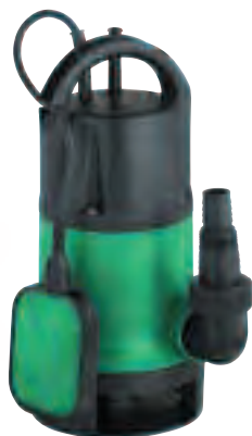
Ref. 95.824 ELECTROBOMBA SUMERGIBLE DRENAJE AGUAS SUCIAS HIDROBEX Con sólidos en suspensión Hidrobex. Ø máx. de paso de sólidos 30 mm., profundidad máx. de inmersión 5 m. 400 W. Caudal máx. 7.500 l/h. Altura máx. de impulsión 5 m. Flotador incorporado y 10 m. de cable. Peso: 4,5 Kg. 42,95€
