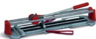
Cód. 26650 CORTADOR STAR-50. RUBI Ligera, con base de aluminio para el corte de cerámica de gres. Rodel 6mm. Wídia incluido. Longitud de corte: 51 cm. Longitud corte diagonal: 36x36 cm. Espesor máximo de corte: < 12 mm. Con separador móvil. Rodel 6 mm incluido.
