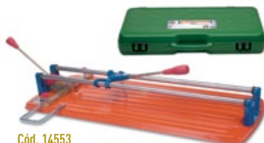
Cód. 14553 CORTADOR CON SEPARADOR TS-60. RUBI Longitud de corte: 66 cm. Longitud corte diagonal: 46x46 cm. Separador monopunto de 400 kg. Ideal para azulejos, gres y porcelánicos de baja dureza. Con tope lateral para cortes repetitivos. Espesor de corte: 6 - 15 mm. Maleta de transporte incluido.
