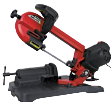
Cód. 80340 SIERRA CINTA SN 1435. STAYER Sierra de cinta.motor monofasico.Potencia 1400 W.2 velocidades.Corte a 45 grados.Velocidad35/70 m min.Dimension hoja 1435x13x0,6.Corte a 90 120.corte a 45 grados 65mm. corte a 60 grados 40 mm. Dotación:Robusta mordaza en fundición, cintra de sierra para hierro y llave de servicio.
