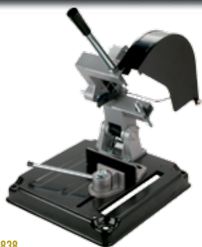
Cód. 71838 SOPORTE PARA AMOLADORAS WOLFCRAFT Soporte para amoladora Ø 180 230 mm para amoladora angular mono y bimanual Ø 180 / 230 mm. Para cortar metal. Dispositivo de sujeción integrado. Acabado sólido.
