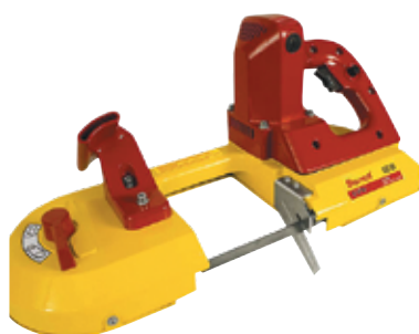
Cód. 75730 SIERRA DE CINTA CORTE ST1010. STARRETT Corta materiales diversos hasta 100mm de diámetro. Arco de magnesio, solo pesa 6,2 Kgs. Velocidad de corte entre 0 y 70 m/min. Desarrollo 1.140 x13 x0,5.
